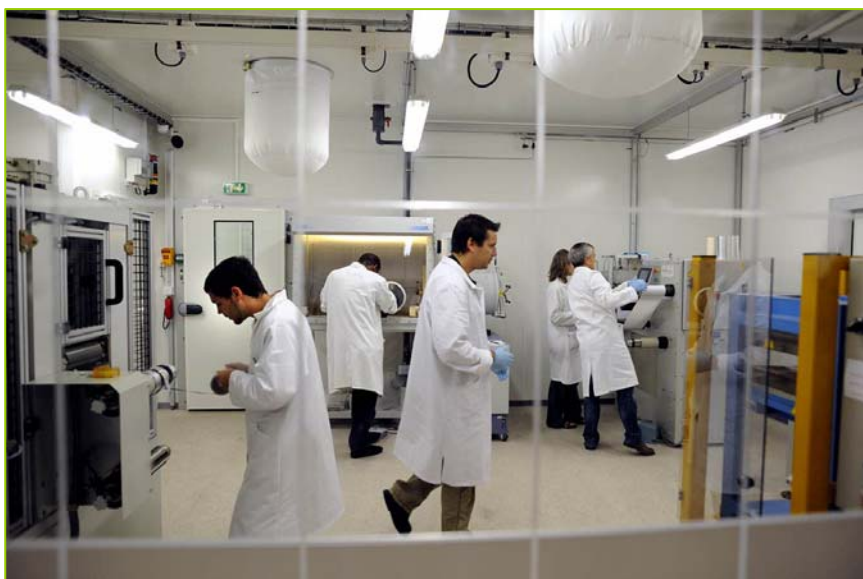
La salle anhydre est une salle à l'atmosphère contrôlée pour la conception des nouvelles batteries. Première tranche du déploiement de la plate-forme STEEVE
